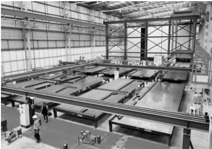
Abb. 5.3 Herstellung von Betonfertigteilen mit einer automatisierten Palettenumlaufanlage
